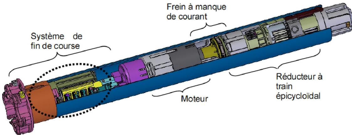
Ce système mécanique de fin de course est composé, comme le montre le schéma de la page suivante, de 2 pignons baladeurs, répartis de part et d'autre du pignon double ( $Z_2$  et  $Z'_2$ ). Ces pignons appuyant chacun sur un capteur de fin de course Haut ou Bas.
