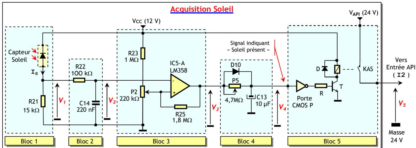
1- Le bloc 1 est un convertisseur courant/tension, qui permet d'obtenir aux bornes de la résistance R21 une tension image de l'intensité lumineuse.
